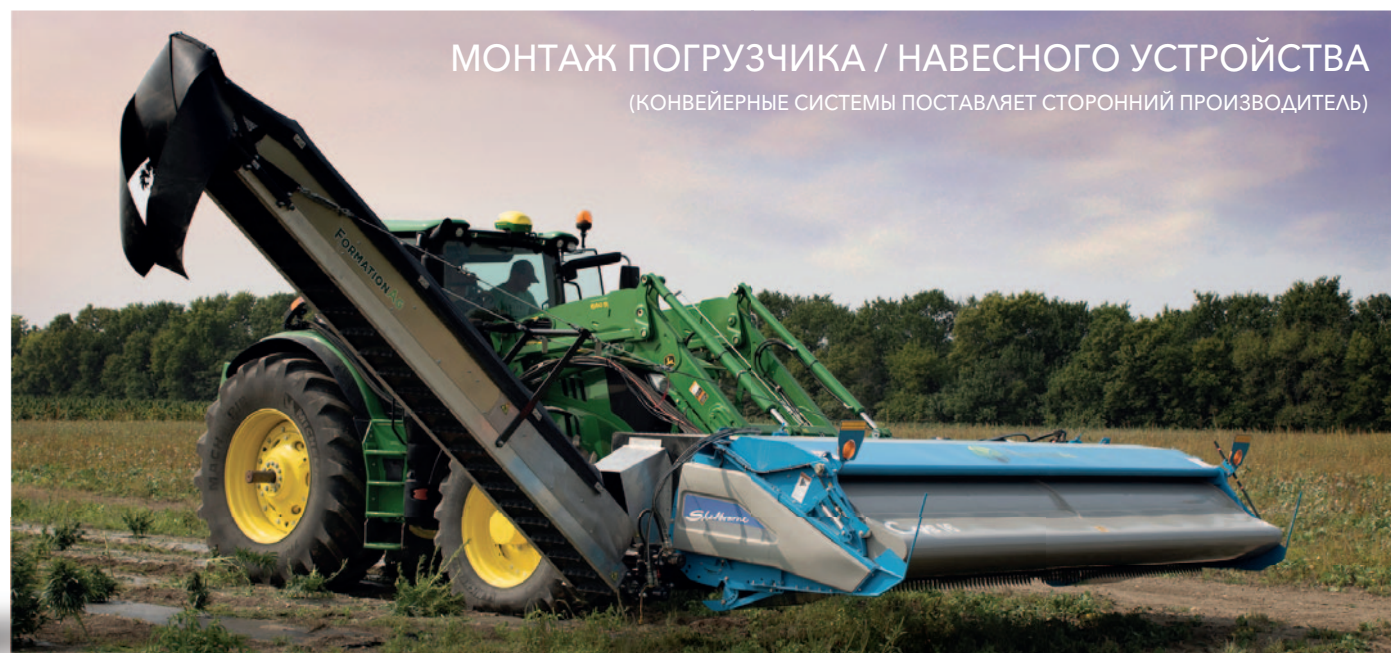
Гидравлический привод – требуемый расход масла 90–100 литров/мин
