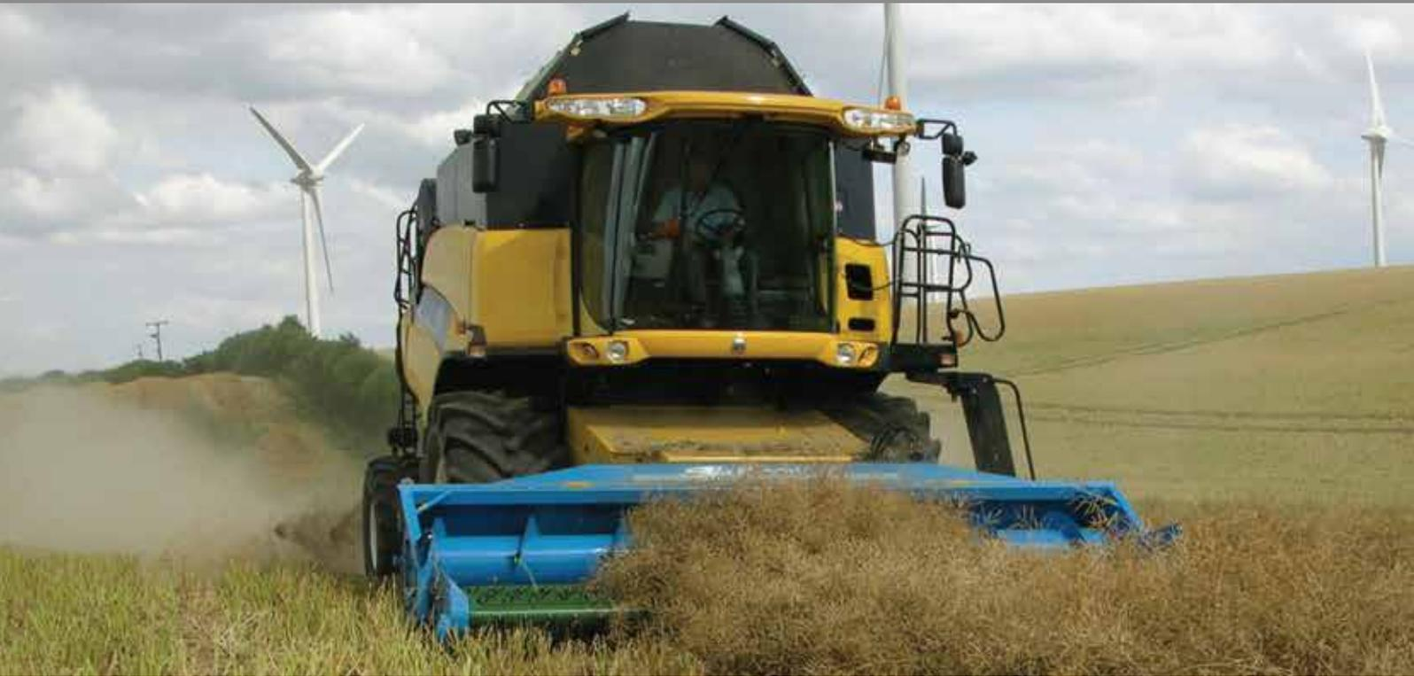
Die Shelbourne-Serie von Pick Up Headern wurde für speziell für das Aufnehmen einer breiten Vielfalt an Mähswaden, einschließlich Weizen, Gerste, Grassamen, Raps und Borretsch, entwickelt. Sie sind dafür ausgelegt, sich mithilfe einer einfachen anschraubbaren Adapterplatte an die meisten modernen Mähdrescher anzupassen.
