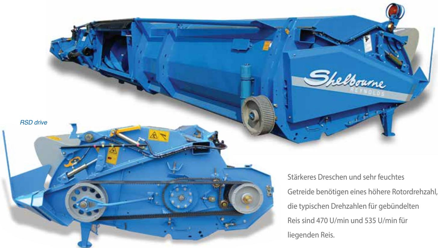
Stärkeres Dreschen und sehr feuchtes Getreide benötigen eine höhere Rotordrehzahl, die typischen Drehzahlen für gebündelten Reis sind 470 U/min und 535 U/min für liegenden Reis.
