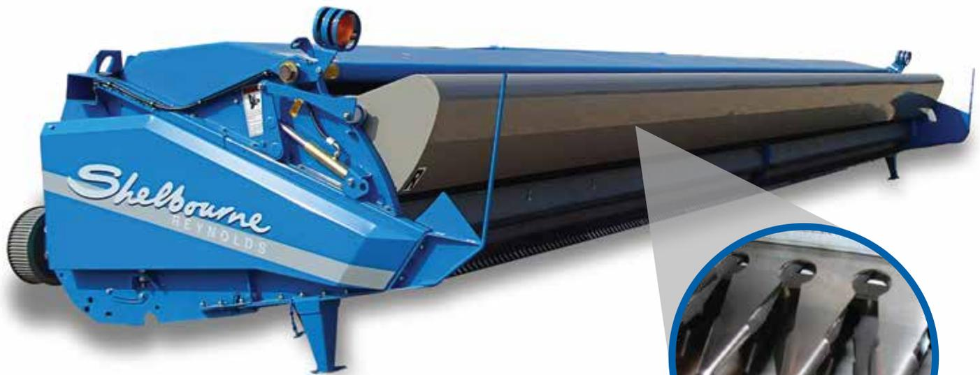
Die RSD Rotordrehzahlen werden verändert, indem drei Änderungsriemenscheiben gewechselt werden. Dieses einfache Antriebssystem überträgt eine maximale Leistung mit einer minimalen Anzahl von beweglichen Teilen
