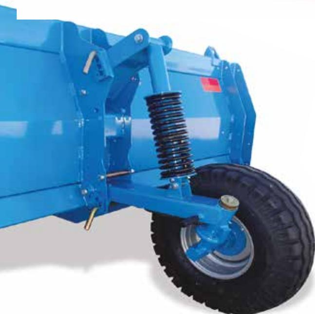
Модельный ряд XCV оснащается копирующими колесами с пружинным нагружением, устанавливаемыми по обеим сторонам переходной пластины. Диапазон положений пальца позволяет располагать колесо на требуемой высоте кошения, а пружинная подвеска обеспечивает широкий диапазон перемещений колеса.
