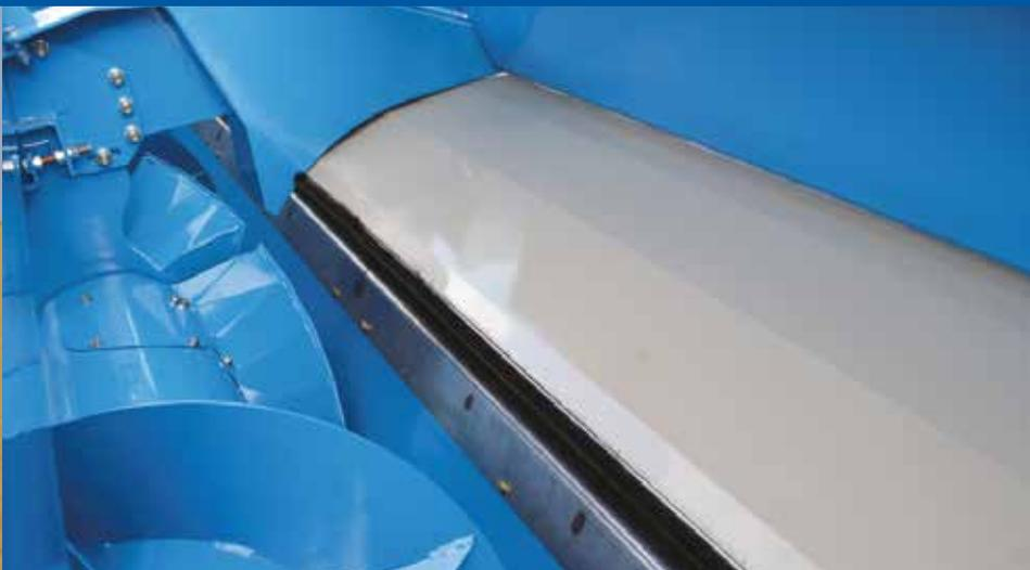
Модель шириной 12,8 метров имеет верхний капот и дефлектор колосьев, опирающиеся на главную заднюю балку.
