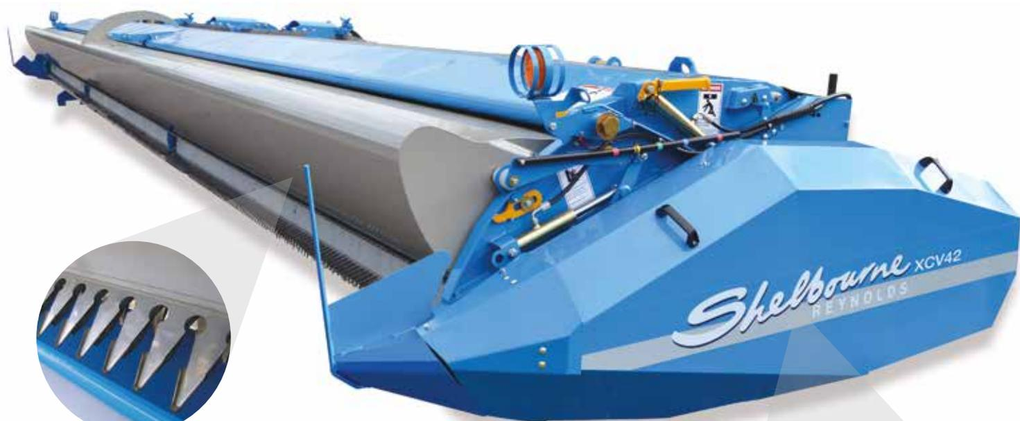
Высокопрочный модульный ротор с пальцами, позволяющими сохранить больше зерна.
